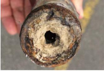
スケール障害とは、冷却水中のカルシウムやマグネシウムなどの硬度成分が配管や熱交換器の表面に付着する現象です。これにより、熱交換効率が低下し、エネルギーの浪費や設備の安定稼働を妨げる原因となります。
